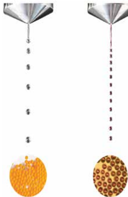
Figura 2. Extrusión simple y extrusión concéntrica..
