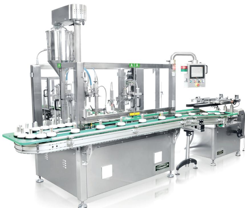
compacta: es de fácil acceso para el operador; incorpora un motor de nueva generación de bajo consumo energético; ofrece sistemas de llenado flexibles; su cabezal de tapado es accionado por un servomotor regulable directamente desde la interfaz persona-máquina; y está diseñado de modo que se puedan poner todos los dispositivos en línea, con una perspectiva de Industria 4.0.
