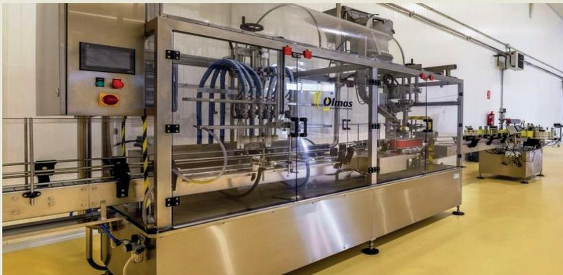
Envasadoras de sistema 100% lineal, en la que la flexibilidad se traduce en la gran capacidad en el envasado multiformato, donde es la máquina la que se adapta a las distintas morfologías de los envases. Llenado volumétrico, másico o ponderal, con distintos sistemas de taponado. Rangos:
