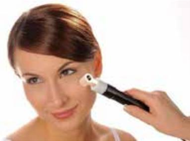
**El Tewameter** cuenta con un método de medición de cámara abierta para evaluar el TEWL.
