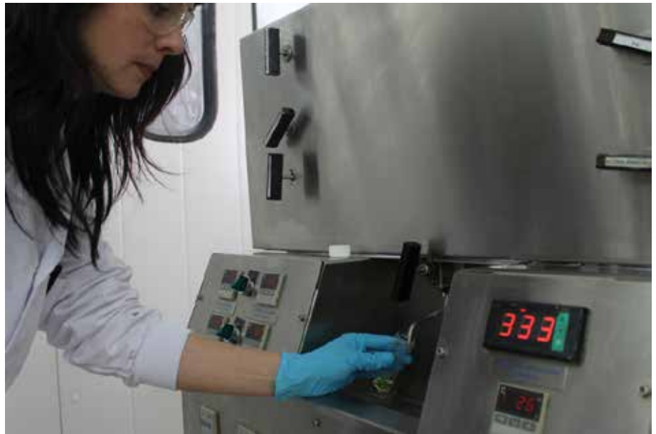
Figura 3. Recogida de extracto supercrítico en la planta piloto de fluidos supercríticos de AINIA.
